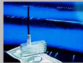
mini transmitter 20 mW 65mm W x 28 mm L x 17 mm D
